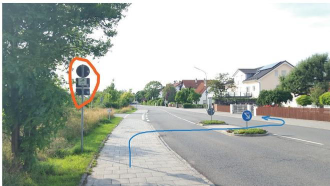
Aus dem Zweirichtungs-Radweg von Ottendichl her werden in Feldkirchen konsequenterweise beidseitige Einrichtungs-Radwege. Der sehr kleine Hinweis zum weiteren Verlauf des Radweges Richtung Norden durch Seitenwechsel über die Querungshilfe soll auf unseren Hinweis hin durch das große gelbe Verkehrszeichen 442 ersetzt werden. **Foto: Basler**
